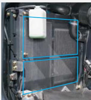
Пылезащитные сетки на капоте (опционные)
