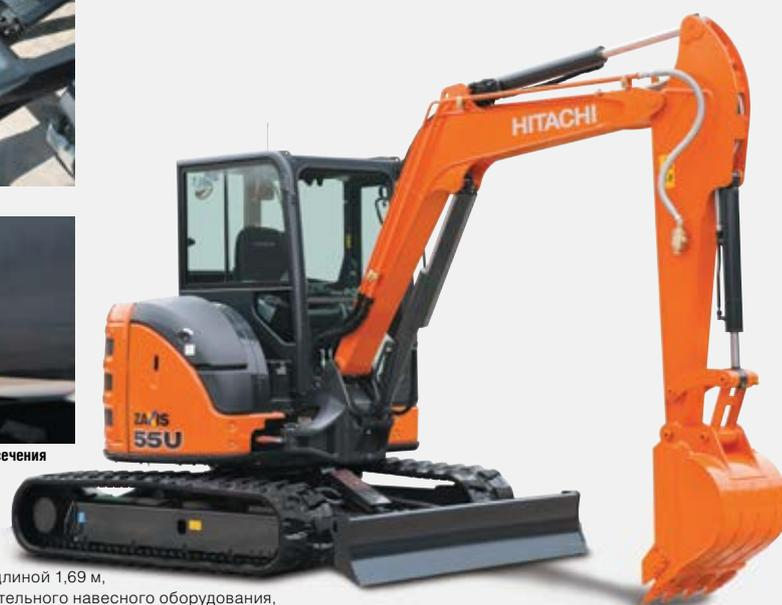
Показан экскаватор в комплектации с рукоятью длиной 1,69 м, трубопроводом для дополнительного навесного оборудования, дополнительным противовесом и зеркалом заднего вида.
