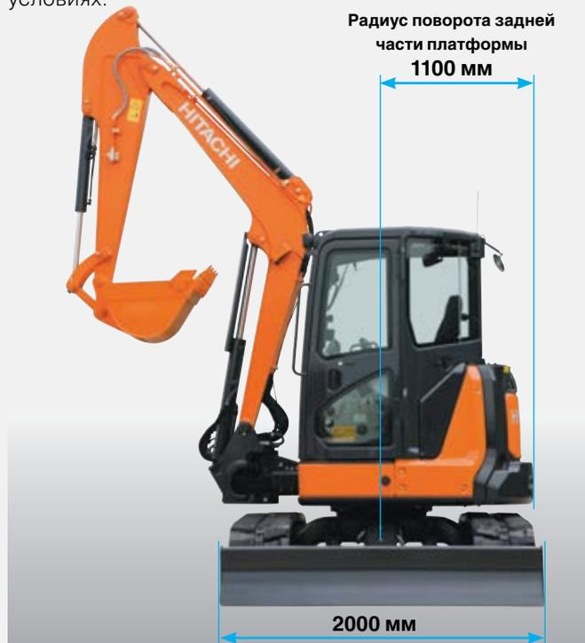
Показан экскаватор в комплектации с рукоятью длиной 1,69 м, трубопроводом для дополнительного навесного оборудования и дополнительным противовесом.
