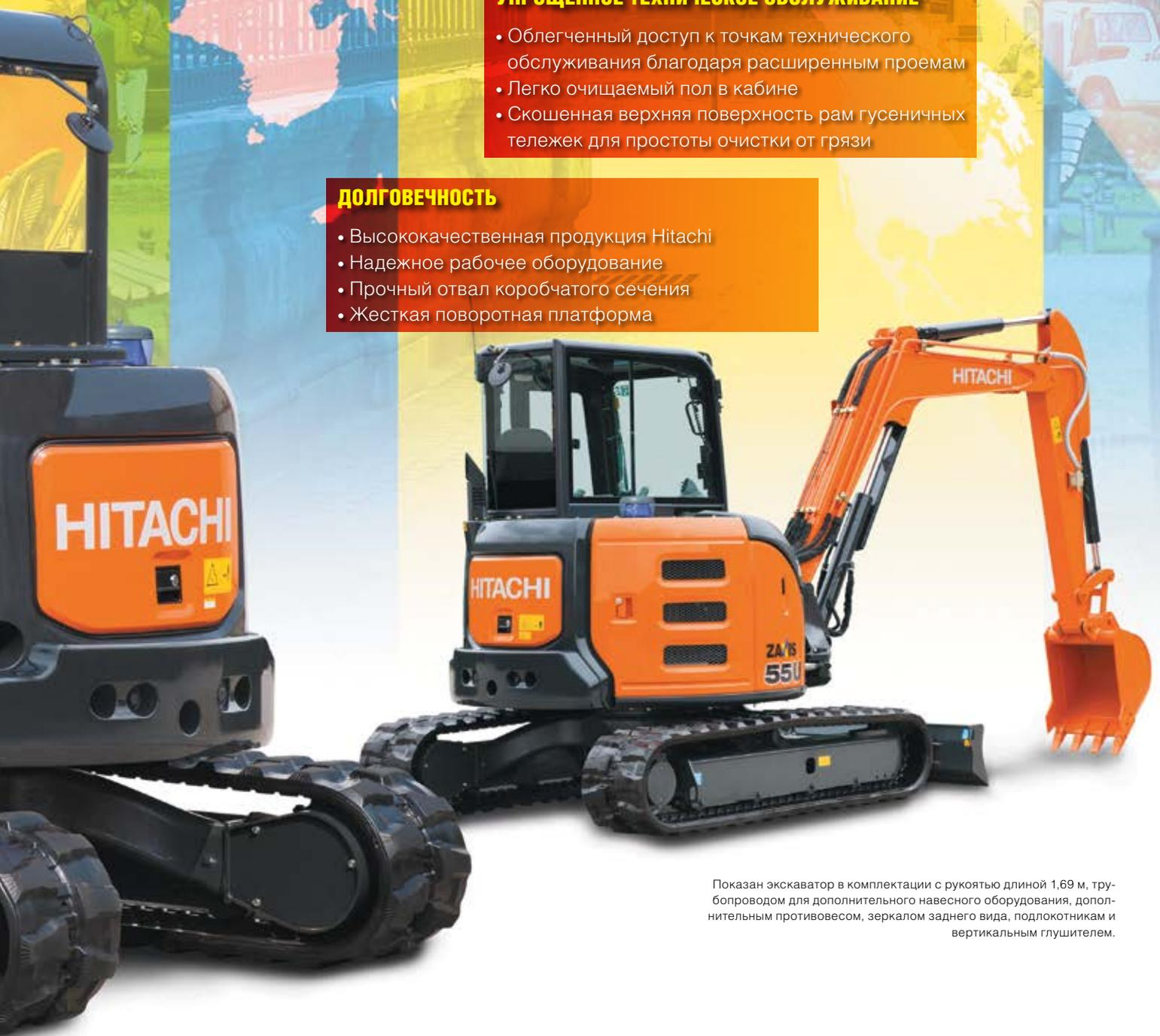
Показан экскаватор в комплектации с рукоятью длиной 1,69 м, трубопроводом для дополнительного навесного оборудования, дополнительным противовесом, зеркалом заднего вида, подлокотником и вертикальным глушителем.
