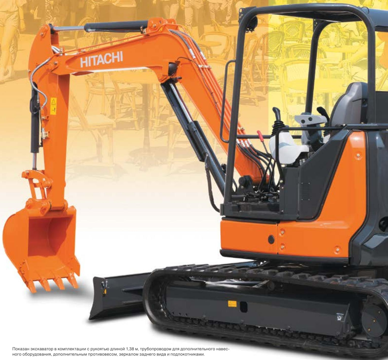
Показан экскаватор в комплектации с рукоятью длиной 1,38 м, трубопроводом для дополнительного навесного оборудования, дополнительным противовесом, зеркалом заднего вида и подлокотниками.
